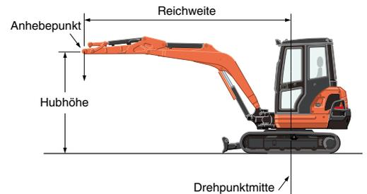
\* Die technischen Daten über den Arbeitsbereich der Maschine wurden mit dem Kubota Standard - Tieföffel ermittelt, ohne Schnellwechseleinrichtung.
