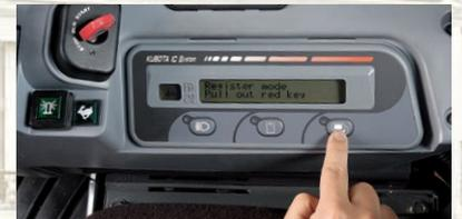
1 Stecken Sie den roten Schlüssel in das Zündschloß und drücken Sie anschließend den rechten Menüschalter mit dem Bildschirmsymbol.
