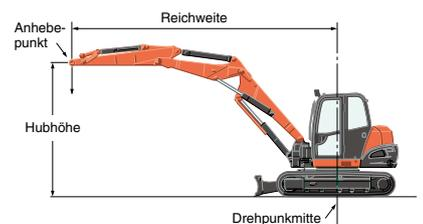
\* Die technischen Daten über den Arbeitsbereich der Maschine wurden mit dem Kubota Standard - Tieflöffel ermittelt, ohne Schnellwechseinrichtung.
