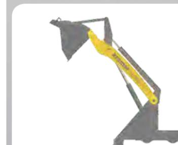
Maximaler Auskippwinkel für einfache Schaufelentleerung
