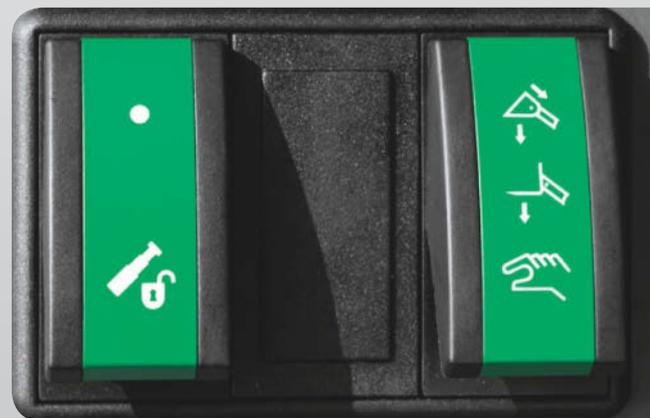
**Smart Handling einfach anwählen:** Ein Moduswechsel erfolgt über den Dreistufen-Wahlschalter (re). Zur Überbrückung von Smart Handling muss der Tastschalter (li) dauerhaft gedrückt werden.
