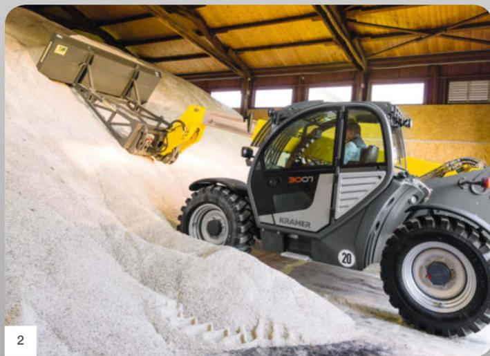
**2 Schutz vor Werteverlust:** Der zusätzliche Korrosionsschutz wurde speziell auf den Einsatz mit aggressiven Medien wie Salz oder Düngemittel ausgelegt.
