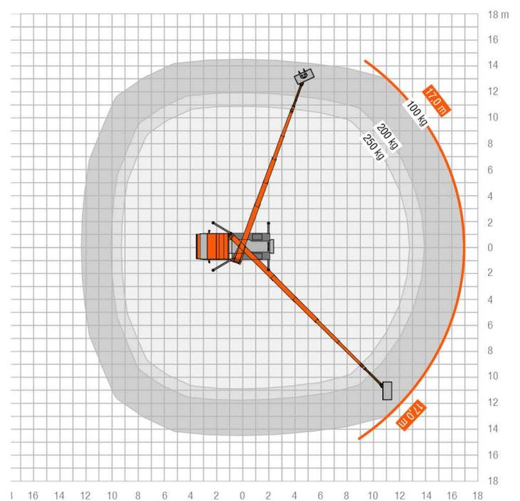
Durch die Neuentwicklung der **Hi-light Performance** Range weist der TBR 260 die höchste Leistungsdatensteigerung im Vergleich mit dem bisherigen Klassenprimus auf. Der STEIGER® TBR 260 brilliert mit satten 26 m Arbeitshöhe und einer **Reichweite von 17 m**. Das übersteigt das Vorgängermodell STEIGER® TBR 250 um Längen.
