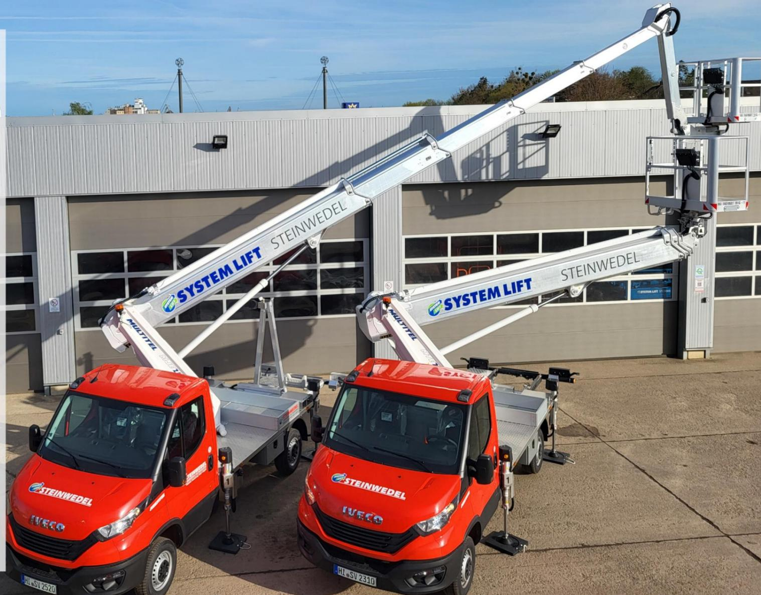
Durch die 450°-Drehturmschwenkung und den 1,40x0,70 m großen selbstnivellierenden Korb mit 120°+120°-Drehung und dem Gelenk-Jib mit 180°-Öffnung kann der Bediener alle Hindernisse umfahren und sich präzise auf dem Arbeitsbereich positionieren.
