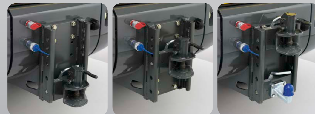
Optimal für unterschiedlichste Einsätze: Die Höhe der Anhängerkupplung kann flexibel angepasst werden.
