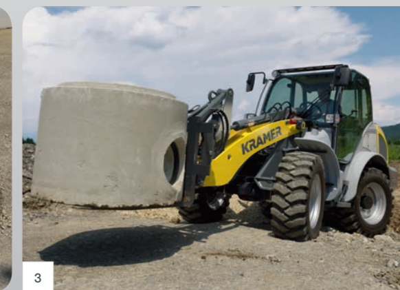
3 Selbst mit hoher Last: konstante Nutzlast bei jedem Lenkwinkel.
