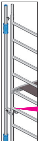
Bild 4: Anschluss Montagepfosten an der Standleiter
