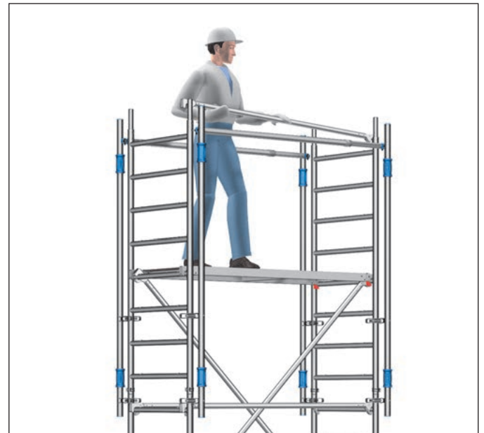
Bild 6: Sichere Montage der Rückenlehnen mit MSG
