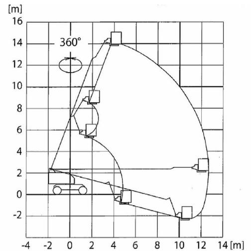
Die selbstfahrende Arbeitsbühne verfügt über einen Teleskopausleger mit einer maximalen Korblast von 270 kg. Die Arbeitshöhe beträgt 15,90 m mit einer maximalen seitlichen Reichweite von 12,60 m. Mit den großen Geländereifen und dem leistungsstarken Yanmar Dieselmotor mit 33,7 KW sowie Dieselpartikelfilter ist diese Maschine vor allem für Außeneinsätze geeignet.
